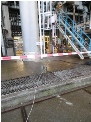
(Door het wegtrekken van de leefluchtslang door de 2 de persoon vanachter de werkplekafzetting ligt er geen spaghetti meer onderaan de koilladder)
